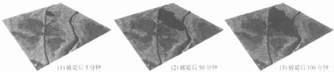
图 3 新川破堤后洪水泛滥过程模拟
